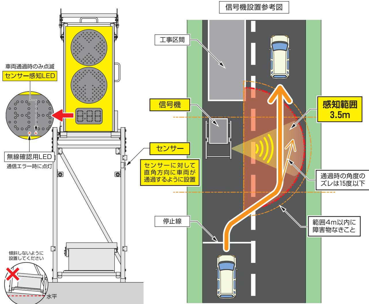
**1** センサーの向きを車道に向けて通過する車両側面とセンサー角度が**15度以内**になるよう設置してください。
