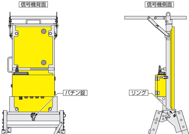
(1) 信号機を折り畳む場合は背面のパチン錠を外し側面のリングを引いてください。
